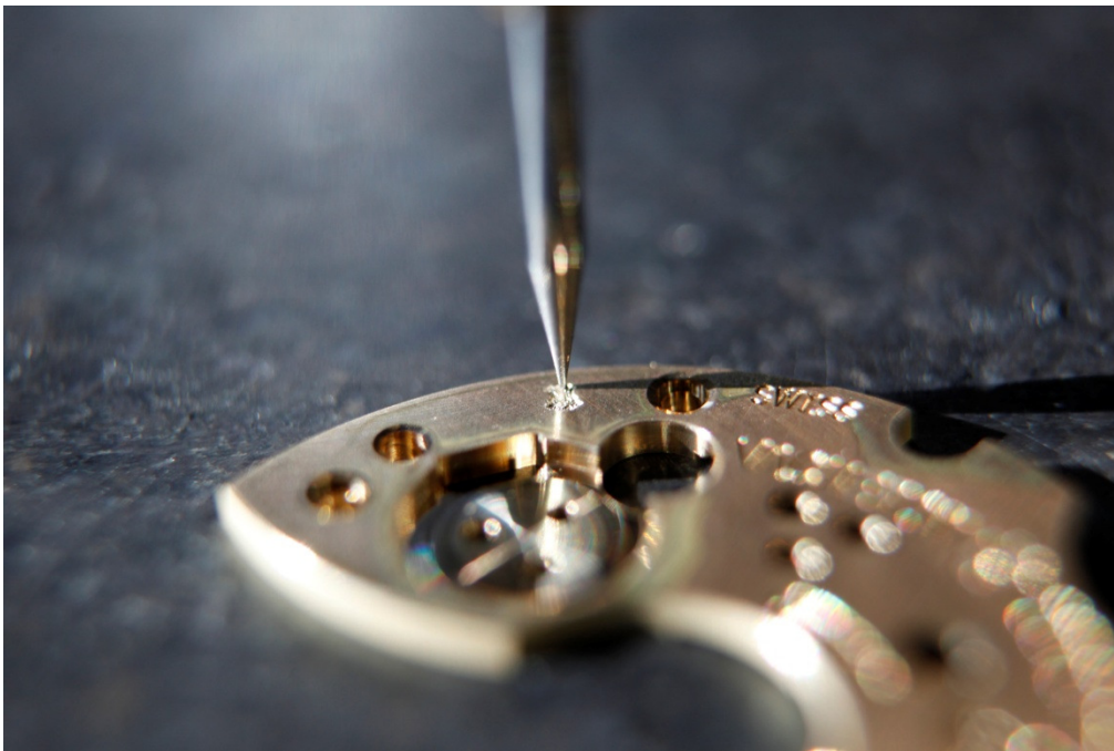
Contrôle de la profondeur de l'insculpation
